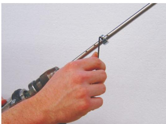
Bei Ausfräsungen für Montagezylinder ZyRillo® muss der Stelling mit der Fixierschraube in der vorhandenen Ansenkung fixiert werden. Für durchgehende Ausfräsungen benötigt es den Stelling nicht.
