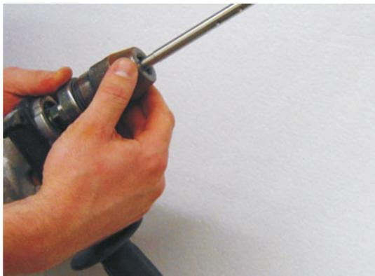
Mitnehmer in das Bohrfutter der Bohrmaschine einspannen.
