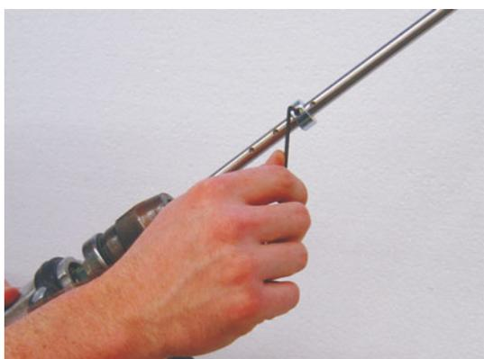
Pour les perçages pour les cylindres de montage ZyRillo®, la bague de réglage doit être fixée à l'aide de la vis de fixation dans la fraisure prévue. La bague de réglage n'est pas nécessaire pour les trous perçants.
