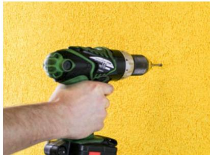
Gewinde durch die Compact- und Aluplatte schneiden.
