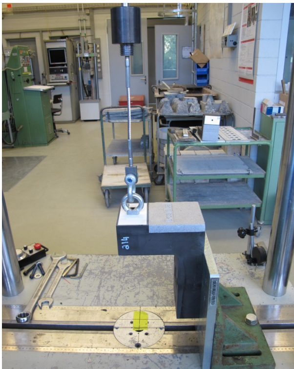
Abb. 10: Versuchsaufbau für die Elementtypen TRA-WIK-ALU RL 200 und TWL-ALU-RL 200, Zug axial.
