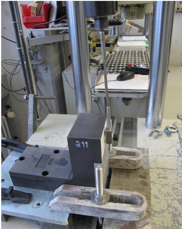
Abb. 9: Versuchsaufbau für die Elementtypen TRA-WIK-ALU RL 200 und TWL-ALU-RL 200, Zug lateral.
