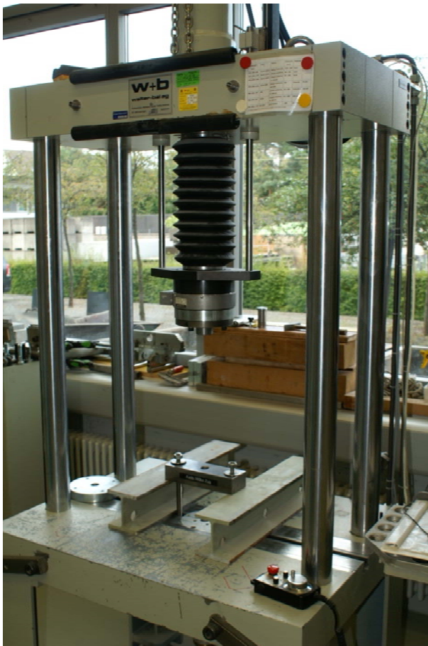
Abb. 5: Für die Versuche verwendete Prüfmaschine (Darstellung ohne Versuchsaufbau für die mechanischen Versuche an den Tragwinkeln).
